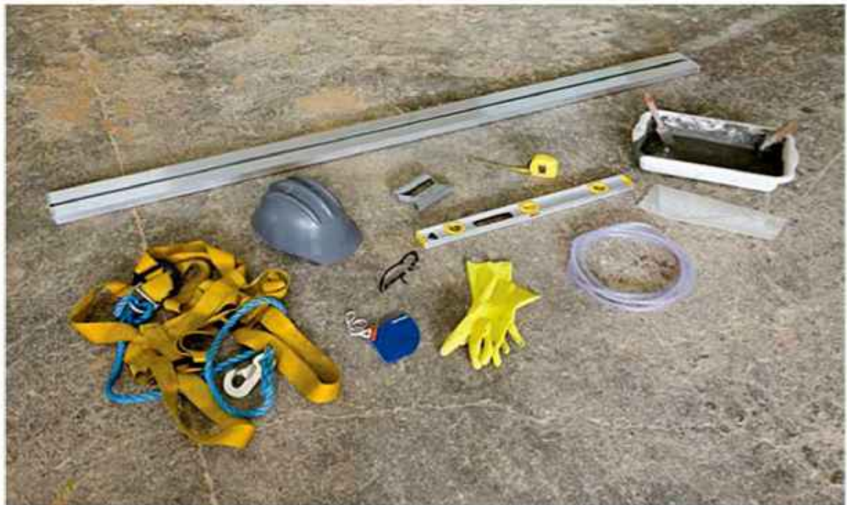
FIGURA 8.2 Principais ferramentas e equipamentos utilizados nas etapas de abertura e execução de membrana impermeabilizante das juntas.
