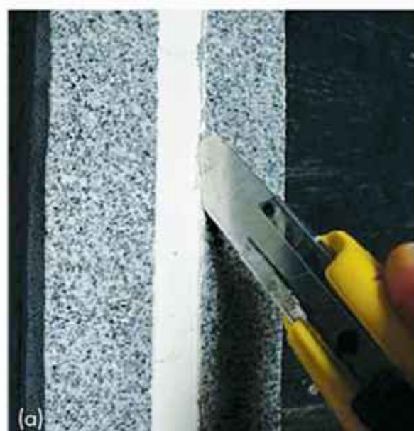
FIGURA 7.9 Teste para verificação da adesão do selante em campo. (BELTRAME e Ioh, 2009).
