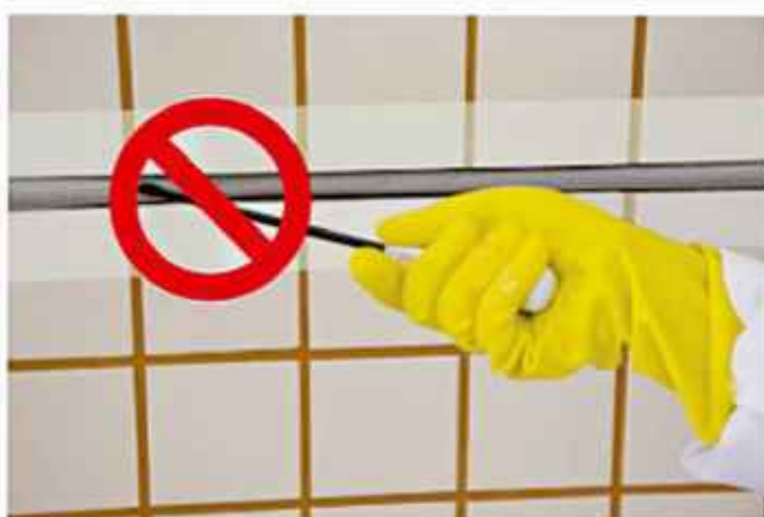
FIGURA 8.17 Nunca pressionar o limitador de profundidade com ferramenta pontiaguda.
