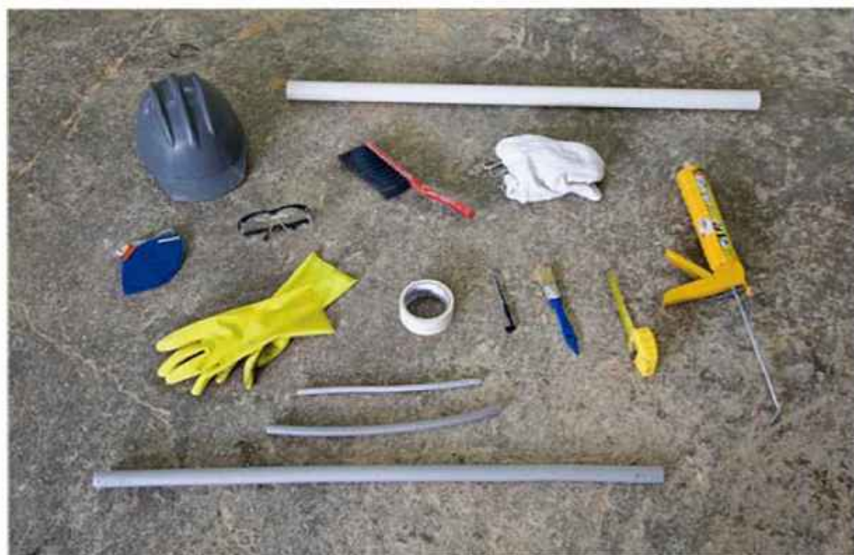
FIGURA 8.4 Principais ferramentas e materiais utilizados na etapa de preenchimento das juntas seladas.
