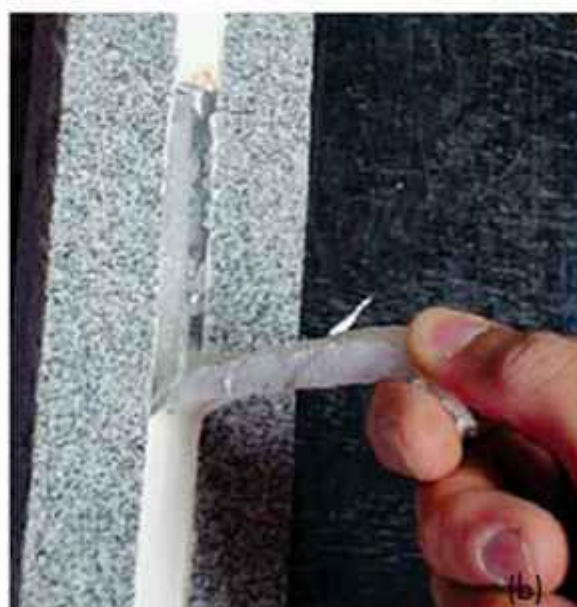
FIGURA 7.9 Teste para verificação da adesão do selante em campo. (BELTRAME e Ioh, 2009).
