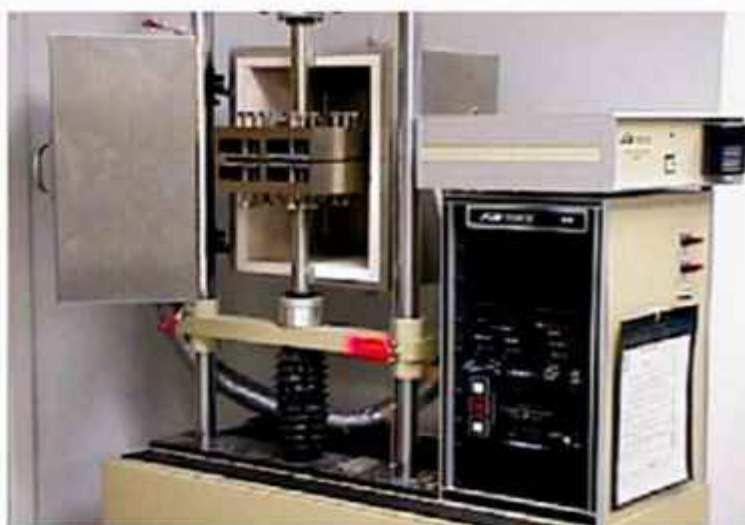
FIGURA 5.8 Equipamento de compressão e tração (Hockman Cycle), empregado na avaliação da adesão e coesão de selantes. Fonte: Dow Corning CO.
