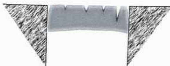
FIGURA 6.3 Enrijecimento do selante, com fissuração e perda da adesão. Fonte: CHEW (1999).
